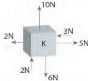
Sürtünmesi önemsenmeyen yatay düzlemdeki K cismine etki eden net kuvvet kaç N'dur?
