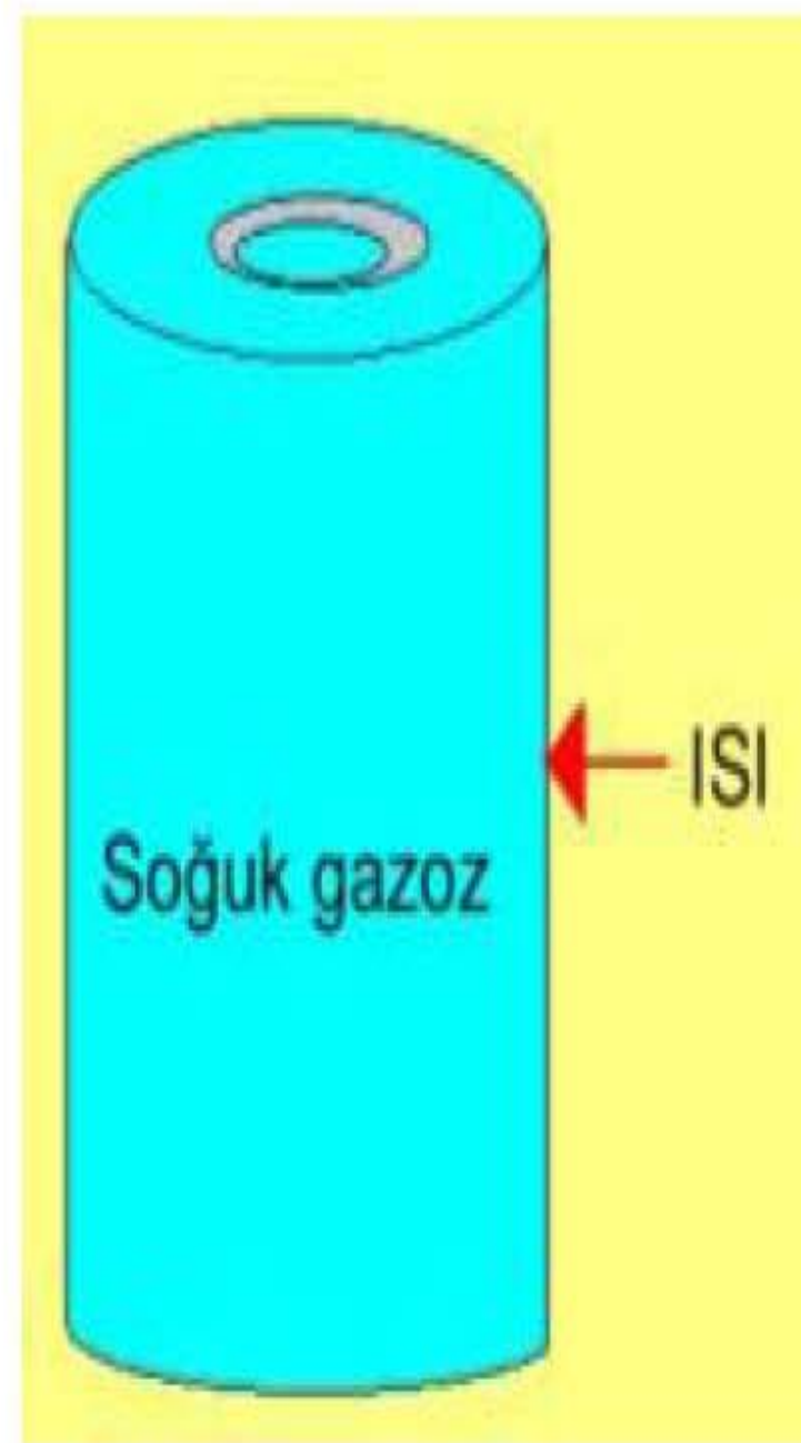
Şekil 1.47: Isı geçişi (soğuktan sığağa)
